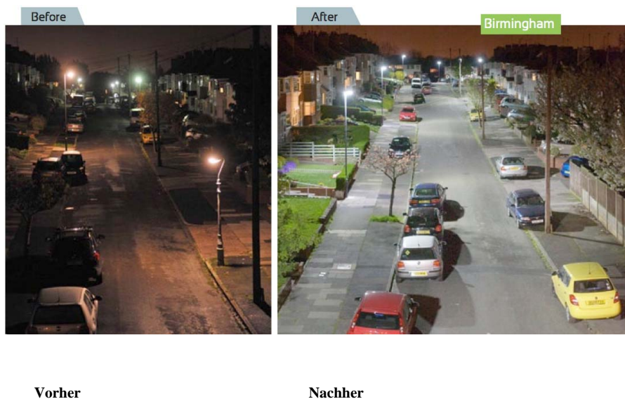
Bild 1: Das Ergebnis des LED-Einsatzes in Birmingham (© Stadt Birmingham und Indal/WRTL)
