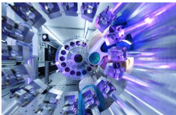
Spiegelsystem eines gepulsten Hochleistungs-Laserverstärkers im Max-Born-Institut in Berlin-Adlershof
